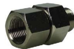
HDRSWIV-3/8 Hochdruck Drehgelenk aus Messing vernickelt; 3/8" IG x 3/8" AG (max. 350 bar / 90 °C) (Auch in Edelstahl HDRSWIV-3/8-R)
