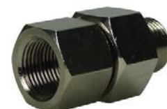
HDRSWIV-3/8 Raccord tournant haute pression en laiton nickelé 3/8" mâle x 3/8" femelle (max. 350 bar / 90 °C) (Aussi disponible en inox HDRSWIV-3/8-R)
