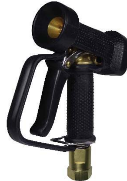
AKMBP01-BL-SWM14-3/4 Avec raccord tournant en laiton avec roulement à bille 3/4 femelle grand débit et joints plats
