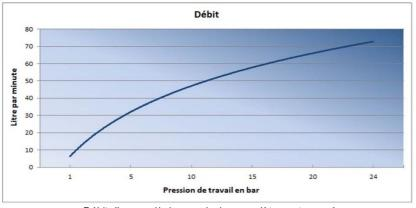
Débit d'eau en l/min avec levier complètement pressée
