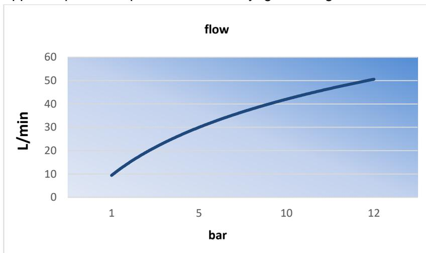
Débit d'eau en l/min lorsque le levier de commande est complètement pressé, en fonction de la pression.
