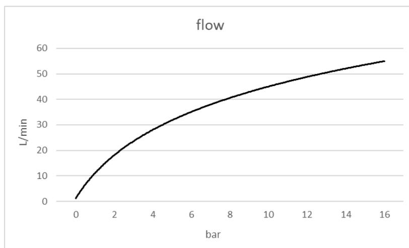
Wasserdurchfluss in l/min bei voll eingezogenem Bedienhebel, abhängig vom Druck
