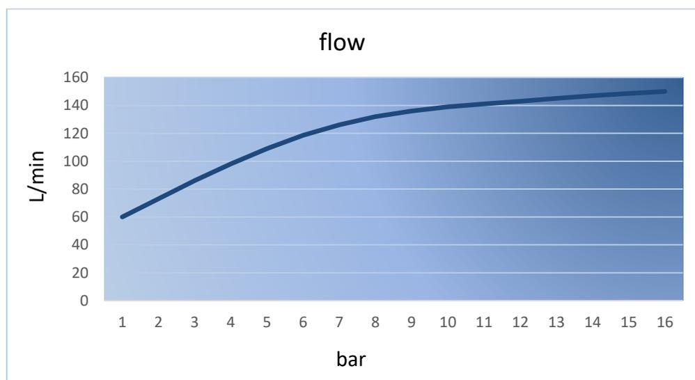
Wasserdurchfluss in L/min bei voll geöffneten Düse, abhängig vom Druck
