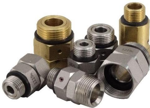
Die Dreharmaturen sind lieferbar aus Messing, Messing verchromt oder Edelstahl (316). Die Dreharmaturen machen die Benutzung von Spritzpistolen leichter und komfortabler, und die Lebensdauer von den Schläuchen wird länger. Die Messingarmaturen haben EPDM (FDA) und die Edelstahlarmaturen haben VITON (FDA) Abdichtungen. Die Dreharmaturen sind einsetzbar bis 30 bar, 95 °C. Andere Abmessungen sind nach Wunsch lieferbar.
