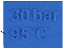
Deutliche Anzeige des maximalen Betriebsdrucks und der maximalen Temperatur.
