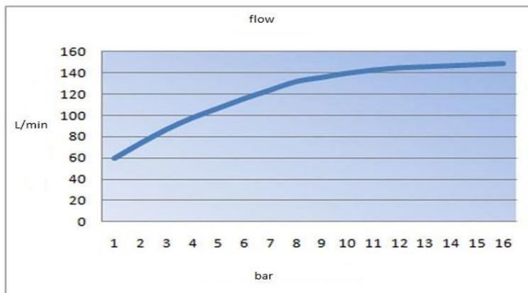
Wasserdurchfluss in L/min bei voll geöffneter Düse, abhängig vom Druck
