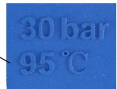
Deutliche Anzeige des maximalen Betriebsdrucks und der maximalen Temperatur.
