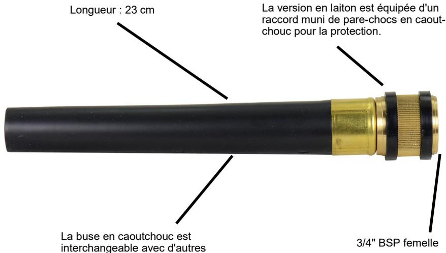
Le Water Saver est fabriqué dans un mélange de caoutchouc adapté à l'utilisation d'eau à une température maximale de 65 °C en utilisation continue ou de 100 °C en utilisation sporadique, avec la protection personnelle nécessaire. Les économiseurs d'eau peuvent être utilisés jusqu'à une pression maximale de 7 bars.
