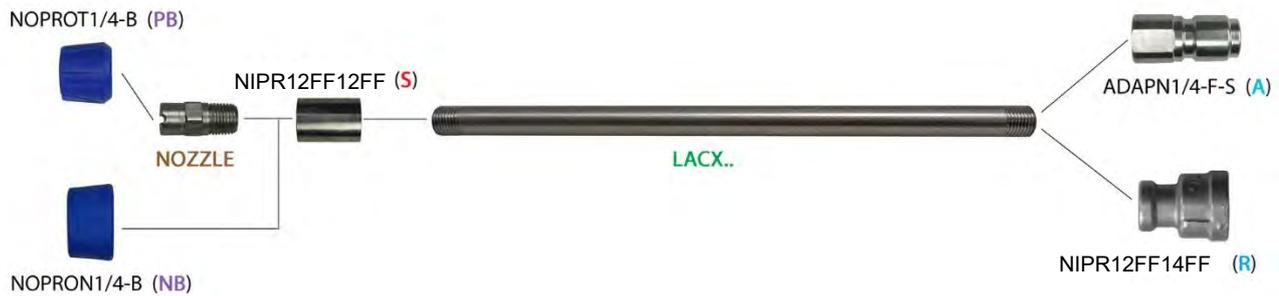
Zum Beispiel wird eine 60 cm lange Lanze mit Schnellkupplung und Düse 2560\* mit blauem EPDM-Schutz mit dem Artikelcode versehen: **LACX06ASPB2560**
