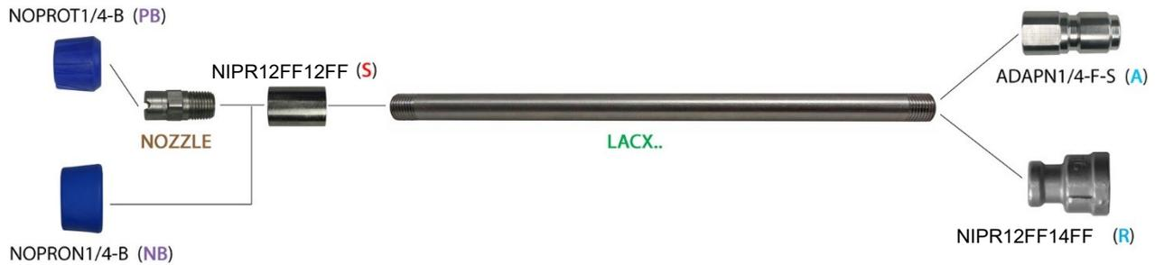
Zum Beispiel wird eine 60 cm lange Lanze mit Schnellkupplung und Düse 2560\* mit blauem EPDM-Schutz mit dem Artikelcode versehen: **LACX06ASP2560**
