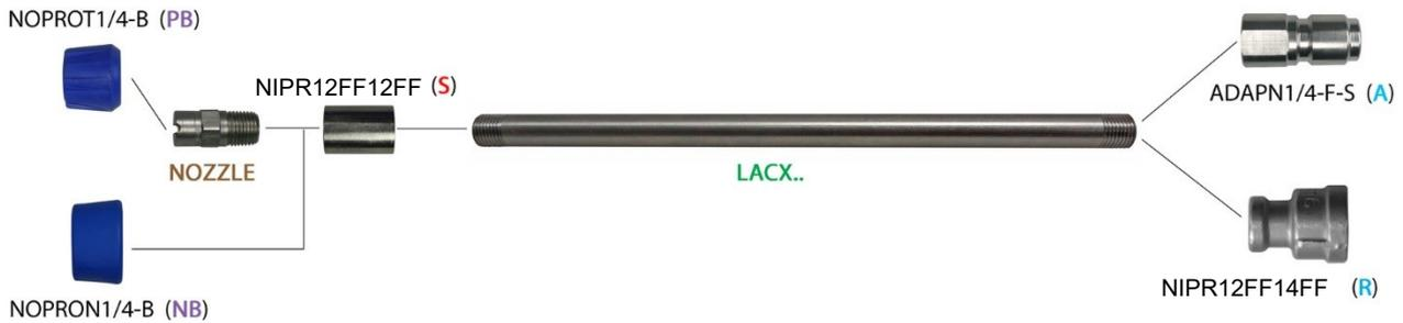
Par exemple, une lance de 60 cm avec raccord rapide et buse 2560\* avec protection EPDM bleue reçoit le code article suivant: **LACX06ASPB2560**
